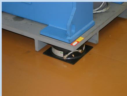
Detail der Lagerung mit Maschinengrundplatte und ISOAIR
