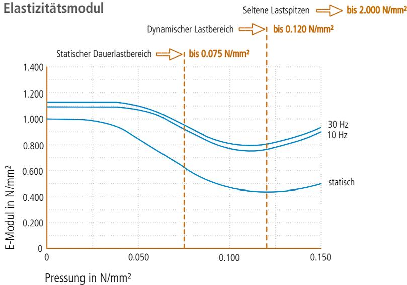
Belastungsabhängigkeit der statischen und dynamischen E-Module.
