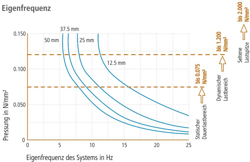
Eigenfrequenz eines Systems bestehend aus einer starren Masse und einer Lage ISOLDYN auf starrem Untergrund.
