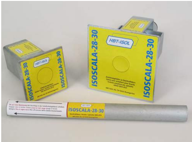
ISOSCALA-28-30: Ideal geeignet bei kleineren Lasten und als Kippsicherung bei gewundenen Treppenläufen. Für Fugenöffnungsmass e 10 bis 20 mm und Tragwiderstand V_{Rd} bis 30 kN.
