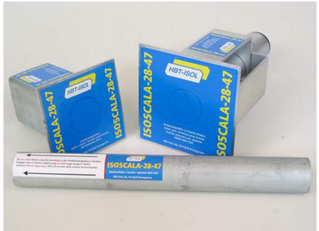
ISOSCALA-28-47: Für mittlere bis hohe Lasten - Tragwiderstand V_{Rd} 47 kN (bei e 20 mm). Fugenöffnungsmass e 10 bis 60 mm. Alle Komponenten sind 3-sprachig beschriftet sowie farblich Typen-codiert.
