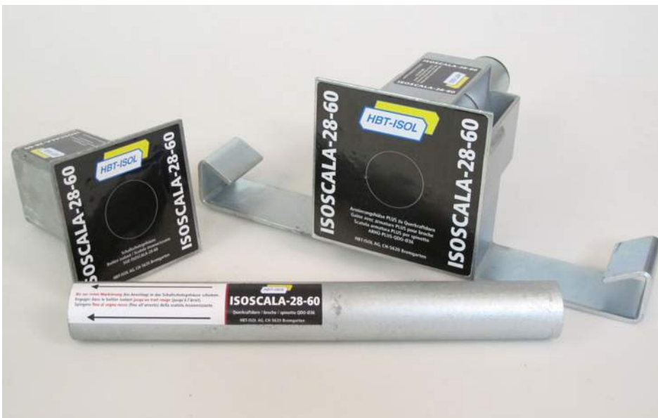
ISOSCALA-28-60: Eignet sich besonders zur Übertragung sehr hoher Lasten. Der zusätzliche Armierungsbügel sorgt für einen Tragwiderstand V_{Rd} 60 kN (bei e 20 mm). Fugenöffnungsmass e 10 bis 60 mm.
