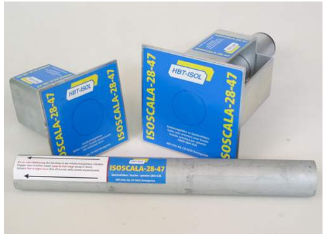
ISOSCALA-28-47: Für mittlere bis hohe Lasten - Tragwiderstand V_{Rd} 47 kN (bei e 20 mm). Fugenöffnungsmass e 10 bis 60 mm. Alle Komponenten sind 3-sprachig beschriftet sowie farblich Typen-codiert.
