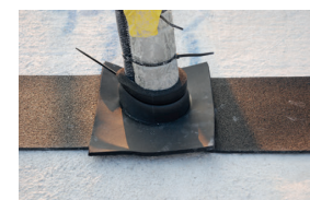
Links: ISOLINE-SPEEDY-027 mit Fussplatte. Rechts: Das ISONOVA Akustik-Trennlager wird unter der Fussplatte des ISOLINE-SPEEDY bis an die Rohrleitung geführt. Das Dichten des Rohrpolsters gegen die Rohrleitung erfolgt mit den mitgelieferten Kabelbindern.
