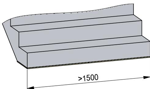
Übersteigt die Treppenlaufbreite das Mass von 1500 mm, werden zwei Treppenlager produziert.
