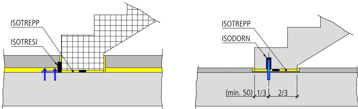
Die Sicherungsdorne ISODORN-A, ISODORN-B und der Sicherungswinkel ISOTRESI werden eingesetzt zur Horizontalsicherung mit gleichzeitiger Schalldämmung von elastisch gelagerten Treppenläufen auf ISOTREPP®-Treppenlager mit F-Form.
