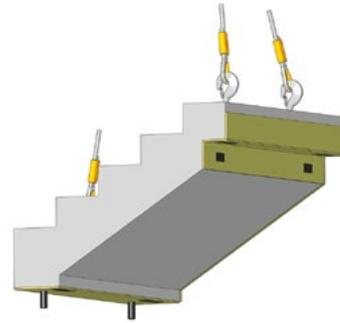
**1** Bereich Austritt: Das Treppenlager ISOTREPP® wird vor dem Versetzen des Treppenlaufes mit Klebemörtel an den vofabrikzierten Lauf geklebt. **Achtung:** Die Treppenlager müssen satt aufgeklebt werden und dürfen keine Hohlstellen zum Element aufweisen.
