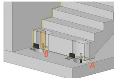
**2** Bereich Treppenfuss, flaches Auflager: Das Treppenlager ISOTREPP® wird auf einen horizontalen Ausgleichsüberzug trocken verlegt. Sicherung durch ISODORN oder ISOTRESI.
