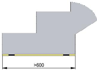
Wird das Mass von 600 mm bei der Treppentiefe überschritten, wird das Treppenlager mit 4 Punkten produziert. Dieses wird eingesetzt bis zu einer Tiefe von 1200 mm. Sobald die Tiefe von 1200 mm überstiegen wird, müssen zwingend die Pläne für die Berechnung mitgesendet werden. Alternativ werden ab 1000 mm auch Vollflächenlager eingesetzt.
