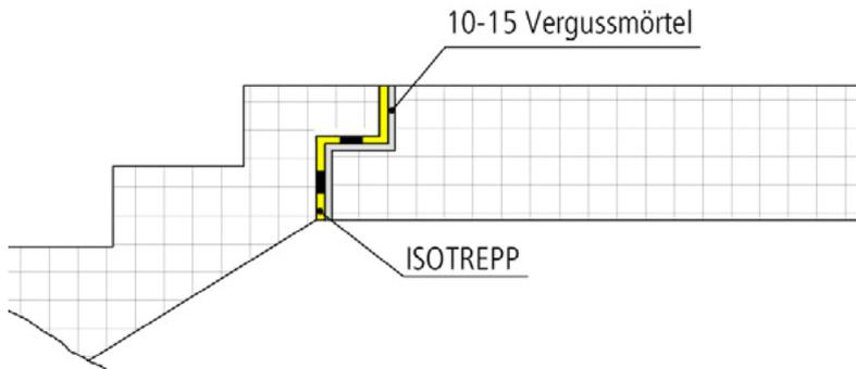
Bei Ausführung mit vorfabrizierten Beton-Elementen ist eine Fugenöffnung von 10–15 mm zwischen dem ISOTREPP® Treppenlager und der Auflagerabwicklung auf der Podestseite einzuplanen. Die Fuge wird nach der Montage des Treppenlauf-Elementes mit Vergussmörtel ausgegossen. Dieser Arbeitsschritt ist in der Einbauanleitung dokumentiert.
