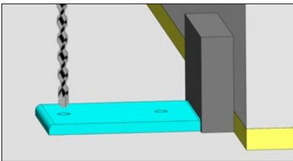
Durch die Löcher im Sicherungswinkel werden je 2 Löcher mit  $\varnothing 10$  mm in der Tiefe von 90 mm in die Bodenplatte\* gebohrt.
