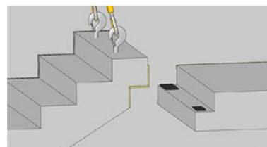
**3a** Schiftplatten ISOSHIFT im Bereich der Lagerpunkte auf dem Podest auf sauberer Auflagefläche positionieren. Durch die ISOSHIFT-Platten in verschiedenen Dicken wird der Treppenlauf auf die genaue Fertighöhe ausgerichtet.
