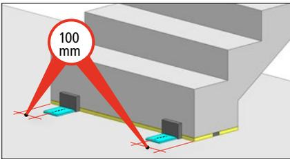
Nach dem Versetzen des Treppenlaufes auf das Treppenlager ISOTREPP® werden pro Lauf 2 Stück des schalldämmenden Horizontalsicherungswinkels ISOTRESI versetzt. Dazu werden diese vor dem Bohren an den Lauf gepresst. Der Achsabstand vom Rand des Treppenfusses bis zum Horizontalsicherungswinkel beträgt 100 mm.
