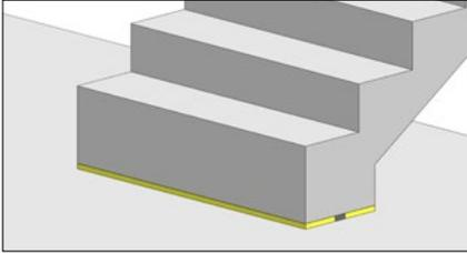
Die Betondecke wird im Bereich des Treppenfusses sauber gereinigt und das Treppenlager ISOTREPP® wird genau positioniert. Sollte ein Höhenausgleich des Treppenlaufes erforderlich sein, wird hierfür unter dem Treppenlager eine Zementmörtelausgleichsschicht aufgebracht, welche vor dem Versetzen des Treppenlagers ausreichend ausgehärtet ist.
