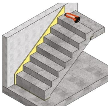
**4** Der überstehende Weichschamstoff ISOPE wird erst beim Einbringen des Treppenbelages mit 1–2 cm Überstand zurückgeschnitten.
