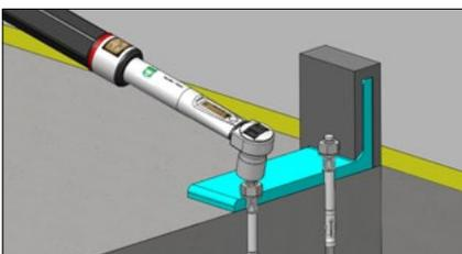
Die zwei Durchsteck-Ankerbolzen des Typs FAZ II M 10 werden durch die Löcher des ISOTRESI in die Bodenplatte eingeführt und nach dem Einschlagen mit einem Anzugsmoment von  $M_b = 45$  Nm festgezogen.
