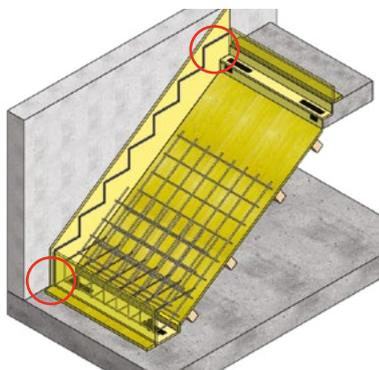
**3** Randstellstreifen ISOPE zur seitlichen Trennung an die Wand kleben. Die Breite des ISOPE-Streifens so wählen, dass der Treppenlauf mit der Abwicklung darauf aufgerissen werden kann. Nach dem Bewehren und der Schalung der Tritte wird die Treppe betoniert.
