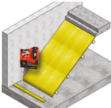
**1** Nach Erstellen der Treppenschalung wird zur Montage des ISODORN ein Loch  $\varnothing$  22 mm mit Mindestdiefe 80 mm in die Bodenplatte gebohrt und leicht mit Vergussmörtel gefüllt.
