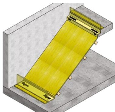
**2** Das Treppenlager ISOTREPP® wird auf den abtalschiernten Untergrund trocken verlegt und im Bereich der Bohrlöcher für den ISODORN ausgeschnitten. Danach wird der ISODORN bis zum Anschlag eingesteckt.
