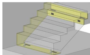
**4** Fuge zwischen Treppenlauf/Wand mit Fugenprofil ISOSTRANG oder Randstellstreifen ISOPE verschliessen.
