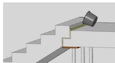
**3b** Bereich Treppenaustritt, L- oder Z-Auflager: Ausrichten des Laufes mit Deckenstützen auf richtiger Höhe. Die Fugenöffnung zwischen Treppenlager und Podest (10–15 mm) wird mit Vergussmörtel ausgegossen.
