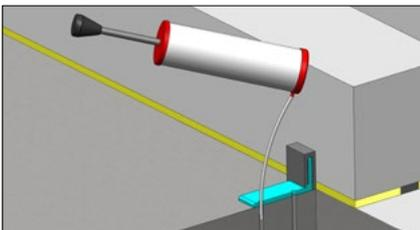
Ausblasen der Bohrlöcher mittels Blasebalg.
