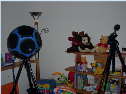
Bauakustische Messungen in den unteren Nutzungsräumen.
